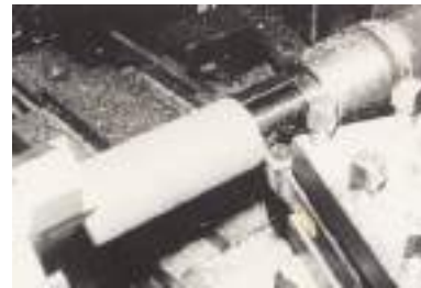
Torneamento do D.E. de um cilindro de bomba de combustível
